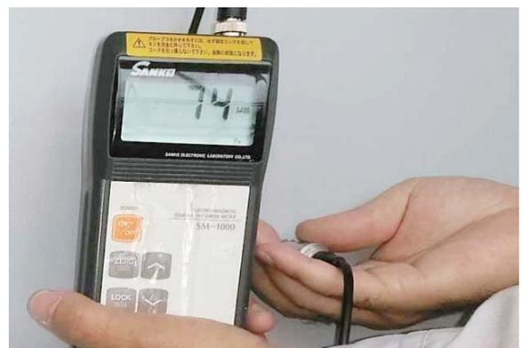
【さび止め塗装の膜厚を測定し記録する】
